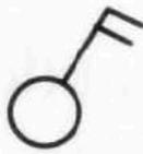
Per scollegare completamente l'utilizzatore elettrico dall'impianto, l'**interruzione** deve avvenire sia sulla **fase** che sul **neutro** ovvero sui due poli. In questo caso bisogna usare un *interruttore bipolare*.
