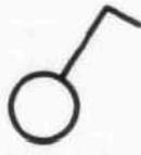
In un sistema monofase la **corrente** elettrica giunge alle varie apparecchiature sfruttando due cavi: la **fase** e il **neutro**. Basta interrompere **indifferentemente** uno solo dei due conduttori per interrompere il **circuito**, la circolazione di corrente e, quindi, il funzionamento dell'apparecchiatura. A questo compito si presta bene l'*interruttore unipolare*, cioè che agisce su un solo polo.
